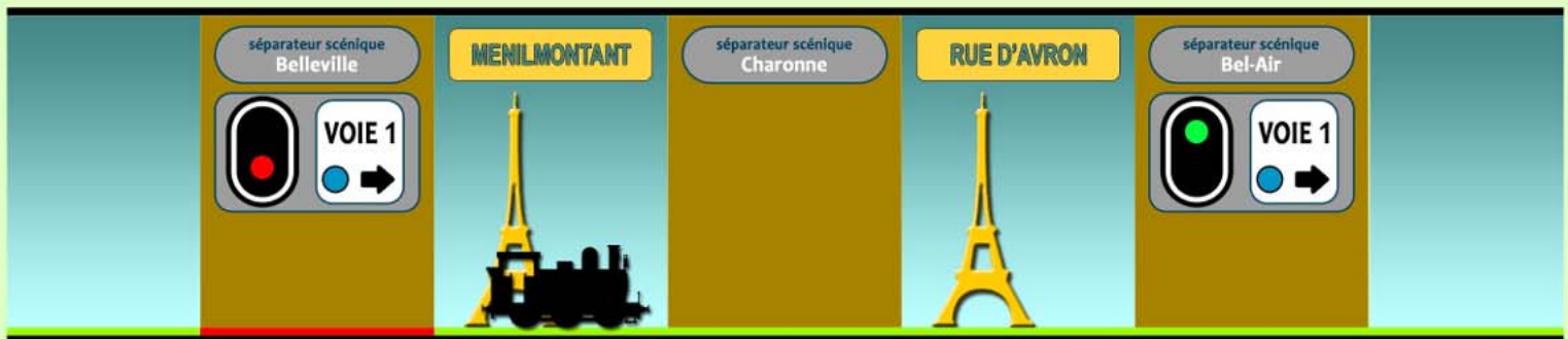
Circulation dans le canton Belleville - Bel-Air protégée par la fermeture du sémaphore de Belleville
